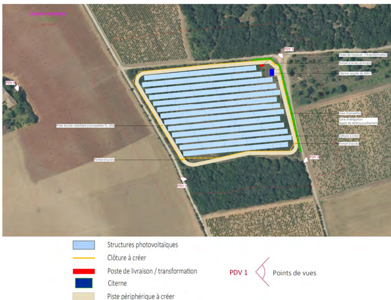
Plan de masse du projet de centrale photovoltaïque (source : demande de permis de construire GDSOL78 – I'M IN ARCHITECTURE)
